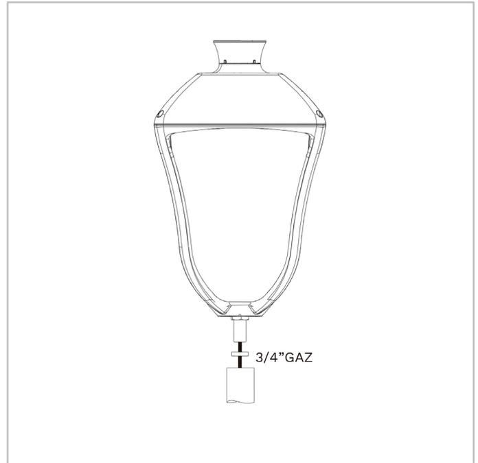
STYLAGE | Montage suspendu avec une fixation femelle de 1" ou 3/4" gaz
