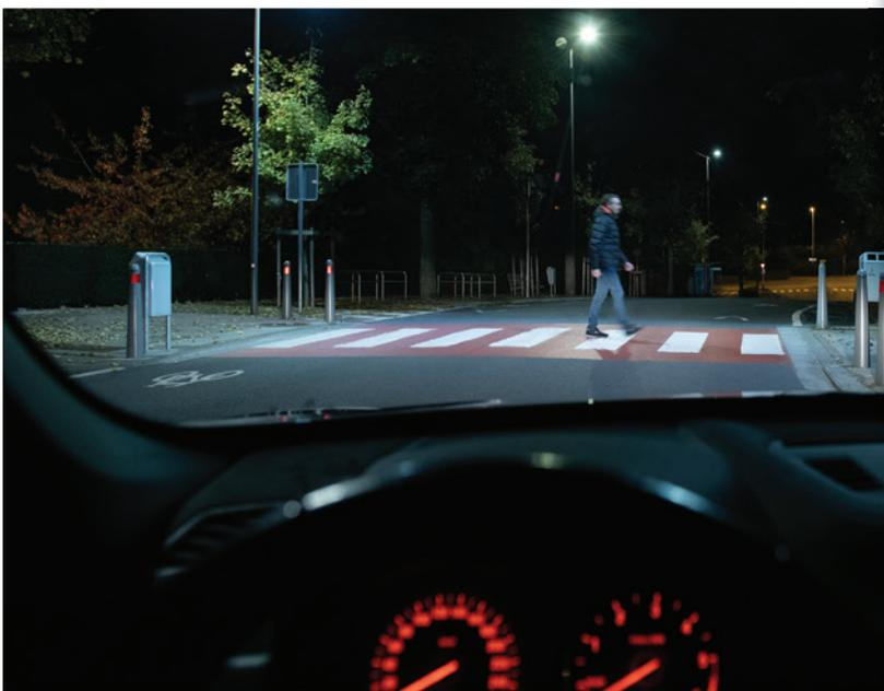
En milieu urbain, le regard du conducteur se porte naturellement sur une centaine de mètres devant lui, selon un angle d'environ  $5^\circ$ . Il est donc important que le piéton apparaisse suffisamment tôt dans son champ de vision. L'éclairage vertical sur le piéton doit permettre au conducteur de voir celui-ci et de réagir en conséquence. A 50 km/h, un automobiliste moyen a besoin d'environ 43 mètres pour s'arrêter.
