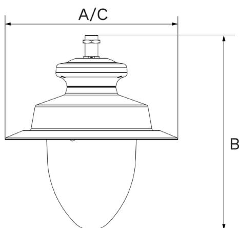
ALBANY GEN2 | Montage suspendu avec une fixation mâle de 1" gaz, 1"-¼ gaz et ¾" gaz
