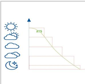
L'ATS 4 inclut 25 niveaux différents pour un réglage précis de l'éclairage en fonction des besoins. Sans sur-éclairage, la consommation d'énergie est limitée au strict nécessaire pour assurer la sécurité et le confort de conduite.
