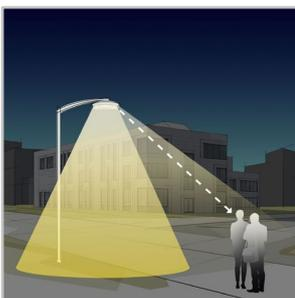
La hauteur d'installation d'un luminaire urbain, par rapport à un éclairage routier, est plus réduite. Dans ce cas, le confort visuel devient un aspect essentiel. Schröder conçoit des optiques et des accessoires permettant de minimiser tout type d'éblouissement (éblouissement distrayant, inconfortable, invalidant et aveuglant). Nos bureaux d'études exploitent un éventail de possibilités afin de trouver les meilleures solutions pour chaque projet
